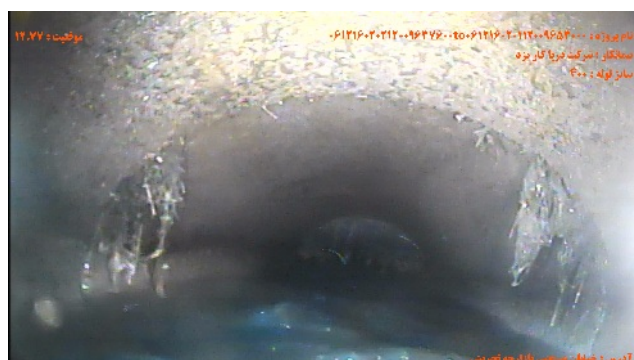
شماره تصویر ۱۲ موقعیت ۱۲.۷۷ کد OJ عنوان اتصال باز / به میزان % قطر
