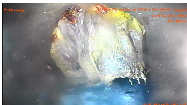
شماره تصویر ۵ عنوان اتصال جانبی معيوب/اتصال معيوب انشعاب موقعیت ۳۱۰۶۵ کد CX
