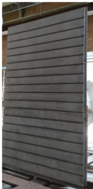
شکل ۱۱-۱۵- نمونه‌ای از نمای نازک بتنی با مواد پلیمری در پانل GFRC
