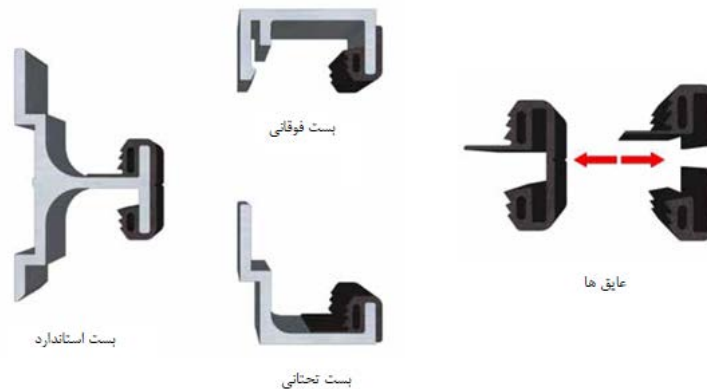
شکل ۷-۵- نصب درزپوش بر روی مهارها
