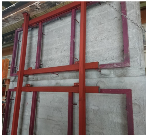
شکل ۱۱-۱۳- نمونه‌هایی از لایه پیوندی و مهارهای انعطاف‌پذیر
